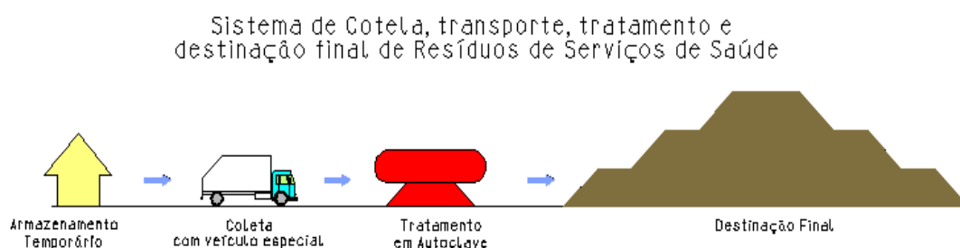
Figura 28– Sistema de coleta transporte, tratamento e destinação final de resíduos de serviços de saúde.
